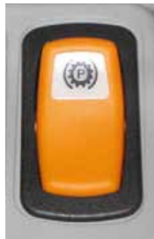
Die elektrische Parksperrre.
