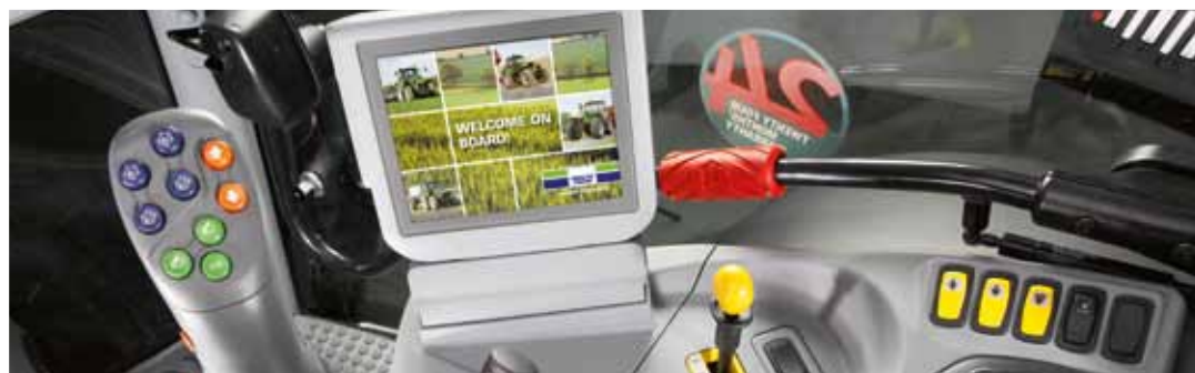
Übersichtlich, leicht zu bedienen und intuitiv zu verstehen, mit zusätzlichen nützlichen Funktionen: der iMonitor von DEUTZ-FAHR (mit ISOBUS kompatibel).
