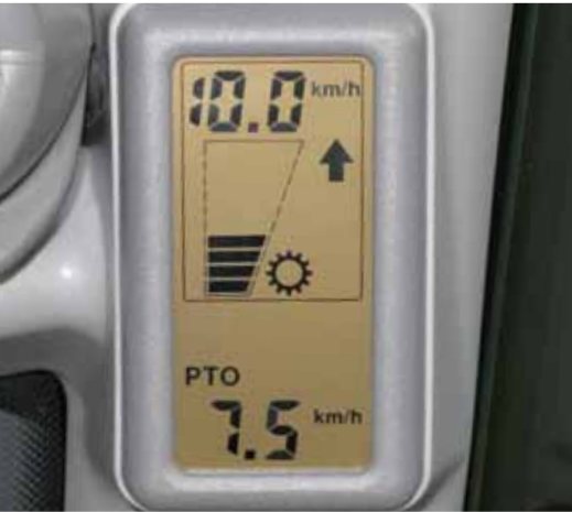
Der Zapfwellen-Modus des Getriebes wird automatisch beim Einschalten der Zapfwelle aktiviert.
