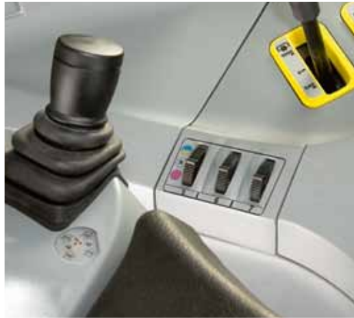
Bis zu sieben Zusatzsteuergeräte können bedient werden.
