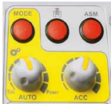
Die Umstellung der Fahrstrategie erfolgt über Bedienelemente in der Armlehne.
