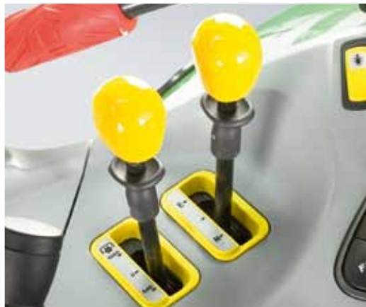
Die Zapfwellengeschwindigkeiten können bequem vorgewählt werden.
