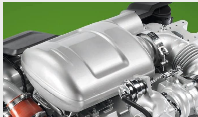
↑ Компактната система DOC (катализатор за диегово окисляване) е система за последваща обработка на отработените газове, която не изисква поддръжка.
