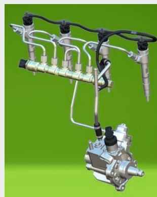
↑ Иновативната инжекционна система Common Rail с 2000 барара осигурява ефективно изгаряне.
