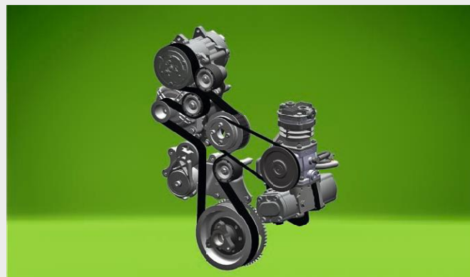
↑ Саморегулиращ се задвижващ ремък. Няма опасност от приплъзване или прегряване.
