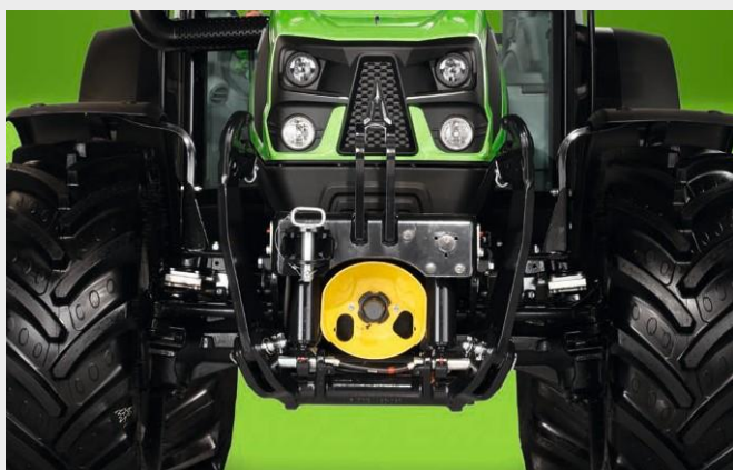
↑ Предният мост е оборудван с две вградени дискови спирачки в маслена баня.
