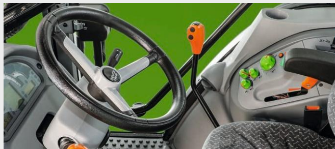
↑ Телескопичен волан с регулируем наклон, може да бъде поставен във всяко положение, за да отговаря на нуждите на водача.
