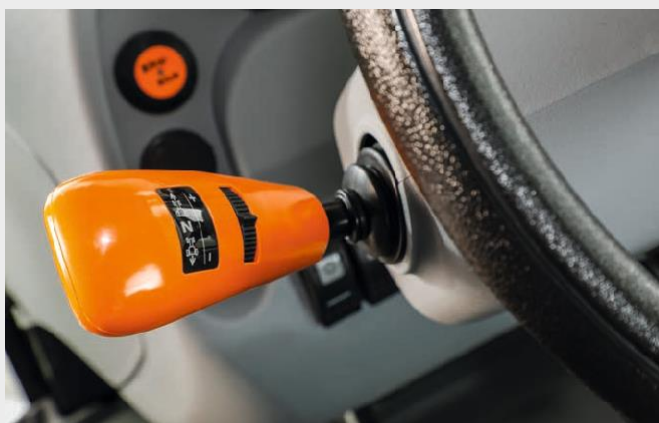
↑ Електрохидравличен реверс Powershuttle с функция SenseClutch.
