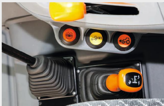
↑ Електрохидравлично задвижване за 4WD и блокировка на диференциала. (LS и GS).
