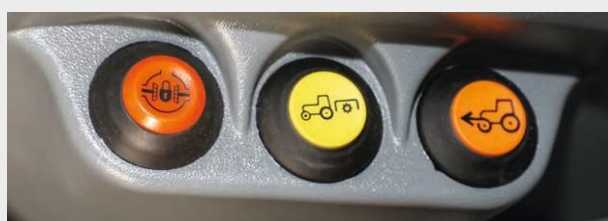
↑ Електрохидравличното управление на ВОМ осигурява комфортна работа и плавен старт.
