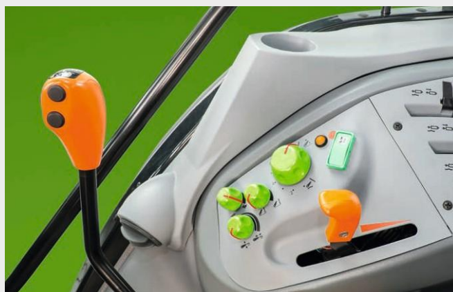
↑ Удобен лост за превключване на скоростите(F45/R45) със странични бутони за превключване под товар.
